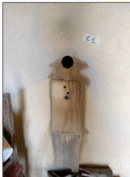
Fig. 9: Prelievo Carota muratura
