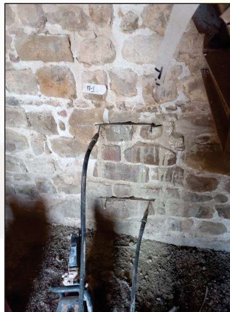
Fig. 5: Prova con Martinetto Piatto
