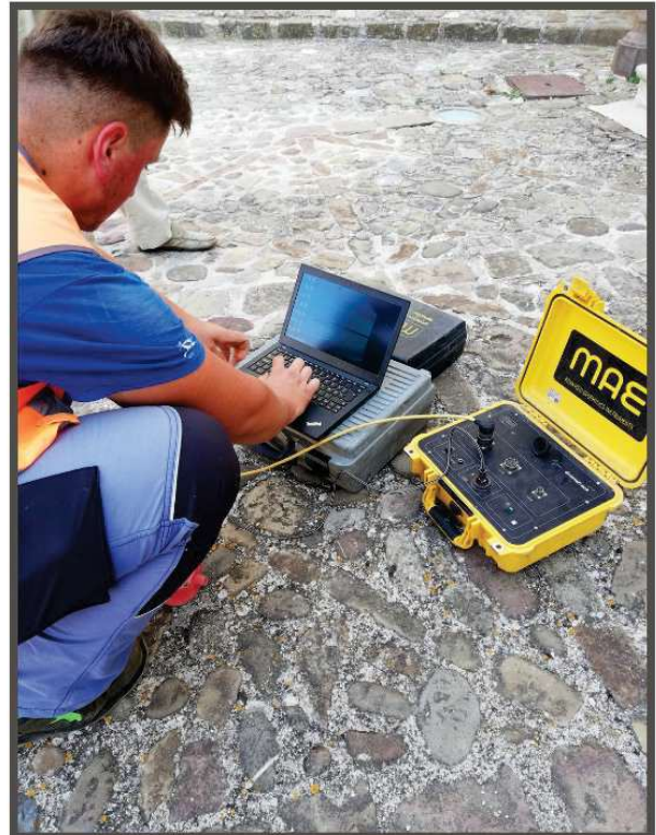
luglio 2024 Prospezione geofisica con tecnica MASW, eseguita con sismografo
