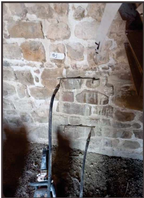
Prova con Martinetto Piatto edificio a monte della torre
