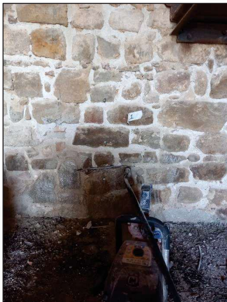
Fig. 4: Prova con Martinetto Piatto
