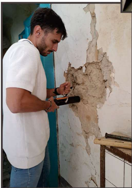
Prove Penetrometrica su malta edificio a monte della torre- pianoterra
