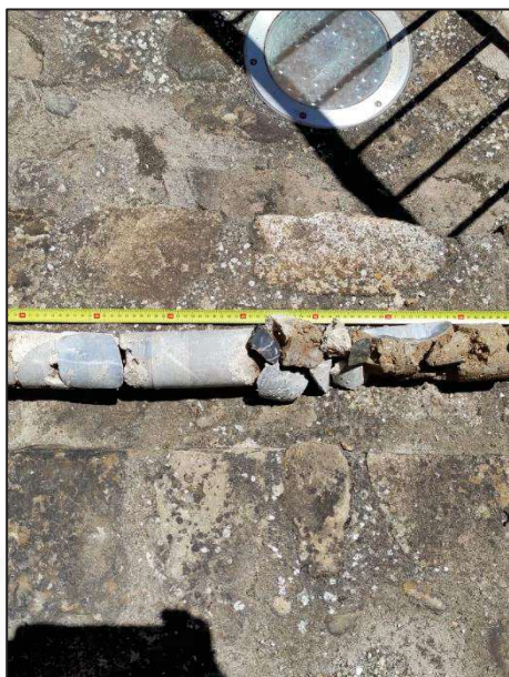
Fig. 8: Prelievo Carota muratura
