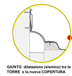
GIUNTO dilatazione (sismico) tra la TORRE e la nuova COPERTURA
