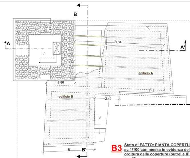
**B3** Stato di FATTO: Pianta COPERTURE sc 1/100 con messa in evidenza della orditura delle coperture (putrelle IPE da cm 12)
